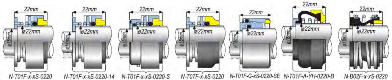
**Подвижные части внешнего механического уплотнения**
