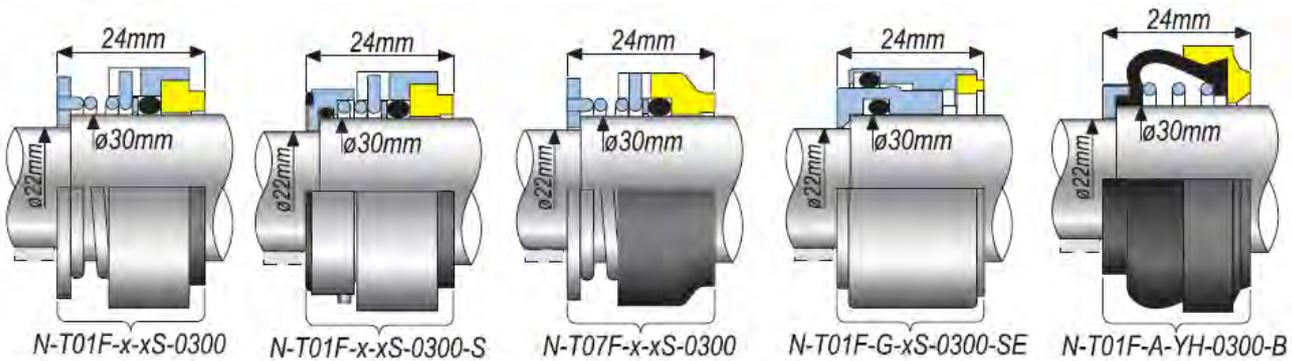
Подвижные части внешнего механического уплотнения
