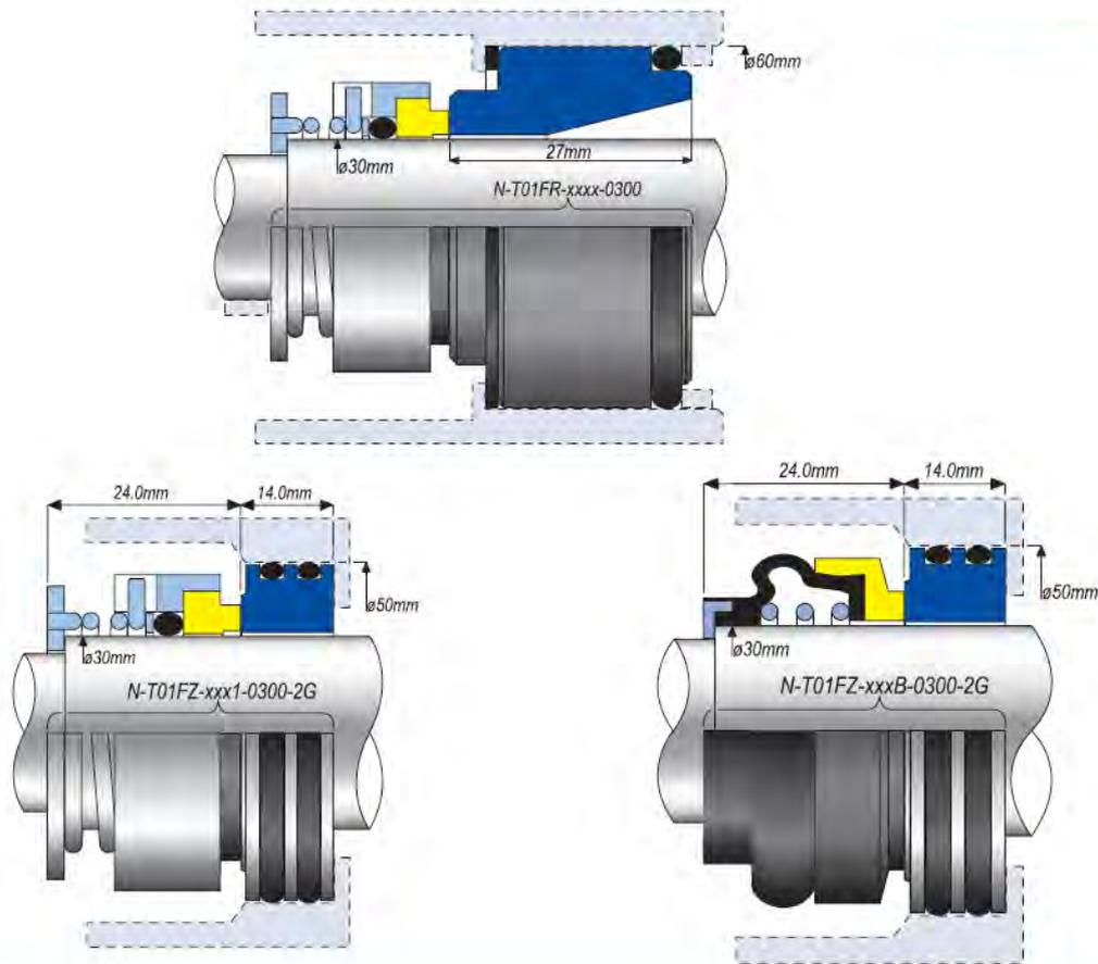
Части уплотнительного узла для насосов Fristam ( $d_{\text{вала}} = 35\text{мм}$ )
